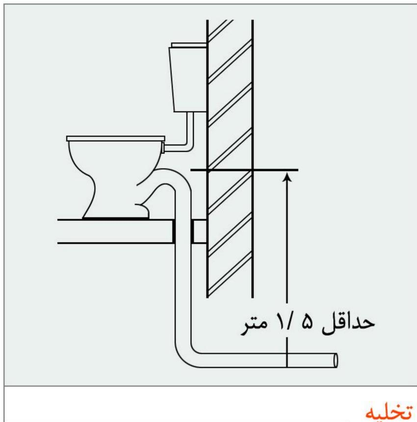
لوله‌های جانبی مرتبط با توالت در طبقه همکف را به شرطی می‌توان به‌طور مستقیم به لوله اصلی تخلیه کننده وصل نمود که فاصله تاج سیفون آن تا کف لوله اصلی تخلیه بیش از ۱/۵ متر باشد (شکل ۳).
